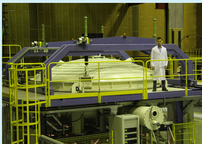
Вакуумная установка диаметром 4000мм
