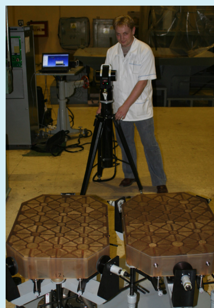
Асферические зеркала для КА «Барс-М»
