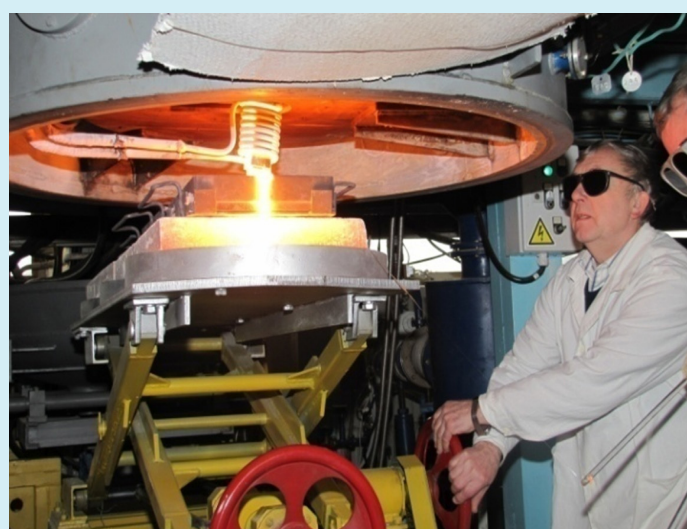
Отлив стекла из индукционной вакуумной печи
