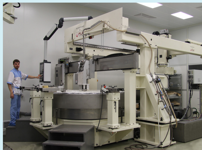
Станок непрерывного полирования плоских деталей
