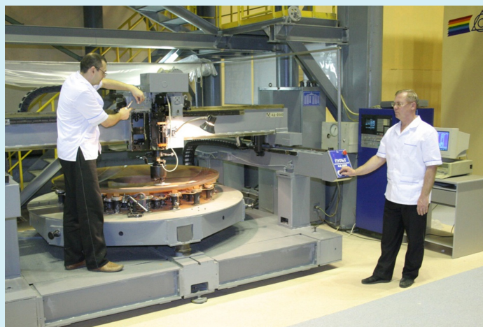
Главное зеркало диаметром 1,7 м КА «Спектр-УФ»
