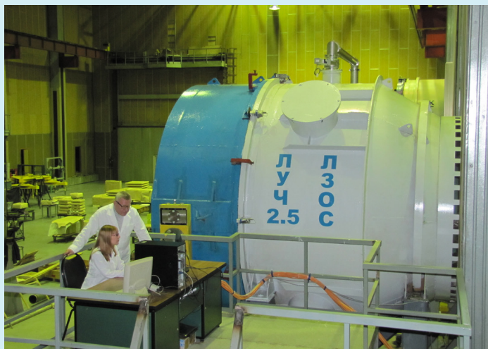
Установка для ионно-лучевой обработки оптических деталей
