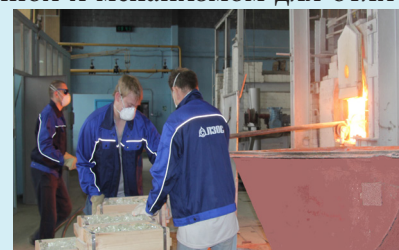
Варка оптического стекла в горшковой газовой печи
