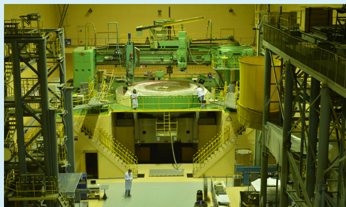
Обработка главного зеркала диаметром 6 метров телескопа БА
